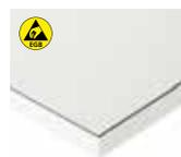
Ober- und Unterseite mit einer leitfähigen, lichtgrauen Melaminharzdirektbeschichtung (nach DIN 68765). Volumenleitfähige Mittellage. Normaler Abriebwiderstand, bedingte Kratz- und Stoßfestigkeit. Stärke 28 mm
